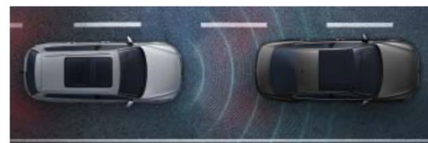
Die automatische Distanzregelung ACC mit Umfeldbeobachtungssystem „Front Assist“ und City-Notbremsfunktion passt Ihre Geschwindigkeit selbst in der Stadt oder bei stockendem Verkehr der des vorausfahrenden Fahrzeugs an, hält den gewählten Abstand ein, warnt vor zu schneller Annäherung und kann im Notfall helfen, schneller zu bremsen.
