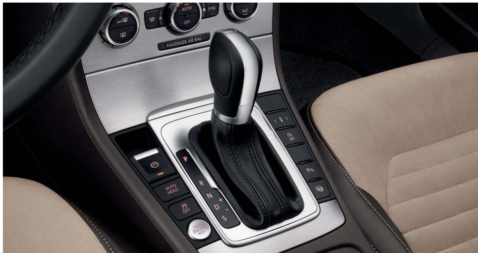
**La boîte séquentielle à double embrayage DSG.** La Passat Berline et Passat SW vous propose en option une boîte à double embrayage qui passe les vitesses de façon non seulement automatique mais aussi sans interruption de motricité. Elle est faite de deux boîtes partielles indépendantes l'une de l'autre. Avantage : le rapport suivant peut être enclenché avant même d'être
