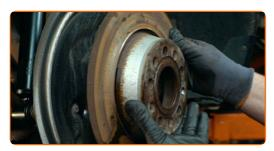
Entfernen Sie die Schutzkappe des Nabenlagers. Benutzen Sie einen Hammer. Benutzen Sie ein Brecheisen.
