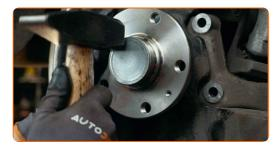
Behandeln Sie die Radnabe an der Kontaktstelle mit der Bremsscheibe. Benutzen Sie ein Kupferschmiermittel.
