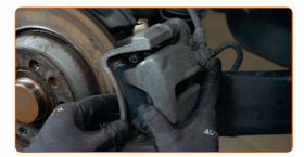
Befestigen Sie die Bremssattelhalterung. Benutzen Sie den XZN #14. Verwenden Sie einen Drehmomentschlüssel. Ziehen Sie ihn mit 72 Nm Drehmoment fest.
