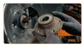
Reinigen Sie den Einbauort für die Nabenlagerung. Benutzen Sie eine Drahtbürste. Verwenden Sie 23 Allzweckreinigungsspray.
