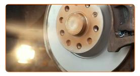
Die Bremsscheibenoberfläche reinigen. Benutzen Sie einen Bremsenreiniger.
