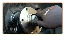
Ziehen Sie das Befestigungselement des Radnabenlagers an. Benutzen Sie den XZN #18. Verwenden Sie einen Drehmomentschlüssel. Ziehen Sie ihn mit 192 Nm Drehmoment fest.
