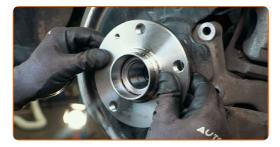
Behandeln Sie die Befestigungen des Radnabenlagers. Verwenden Sie ein Dichtmittel.
