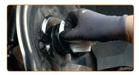
Die neue Radnabe mit einem Lager montieren. Verwenden Sie einen Druckstücksatz mit Ein-/Auspresswerkzeug. 24 Benutzen Sie einen Hammer.
