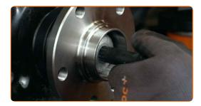
Installieren Sie die Schutzkappe des Nabenlagers. Benutzen Sie einen Hammer.
