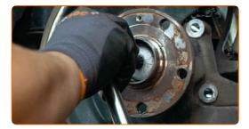
Entfernen Sie die Befestigungsschraube.
