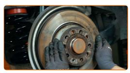
Ziehen Sie die Befestigung der Bremsscheibe fest. Verwenden Sie den Torx T30. Verwenden Sie einen Drehmomentschlüssel. Ziehen Sie ihn mit 9 Nm Drehmoment fest.
