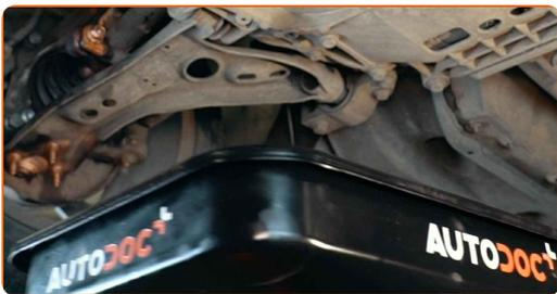
**12** Reinigen Sie den Bereich um die Ablassöffnung der Ölwanne. Benutzen Sie eine Drahtbürste. Verwenden Sie Allzweckreinigungsspray.
