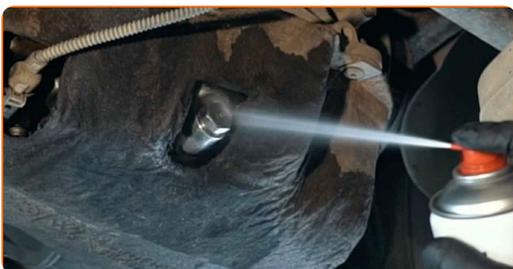
**13** Drehen Sie die Ablassschraube heraus. Verwenden Sie Stecknuss Nr. 19. Verwenden Sie einen Ratschenschlüssel.
