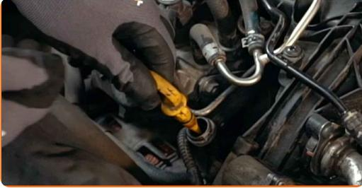
6 Reinigen Sie den Deckel des Ölfilter-Gehäuses. Verwenden Sie Allzweckreinigungsspray.
