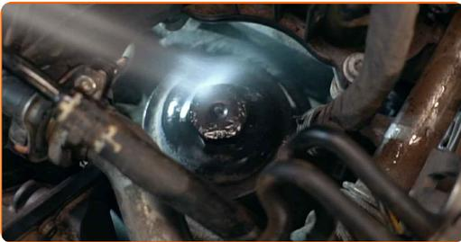
7 Schrauben Sie den Filtergehäusedeckel zusammen mit dem alten Filterelement ab. Verwenden Sie Stecknuss Nr. 30. Verwenden Sie einen Ratschenschlüssel.
