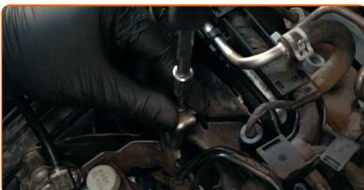
28 Entfernen Sie die Öleinfüllschraube.
