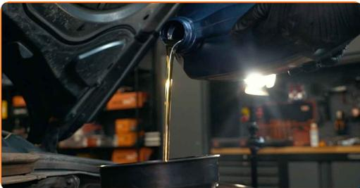
Austausch: Motoröl und Ölfilter – VW Passat B7 Variant (365). AUTODOC-Experten empfehlen:
