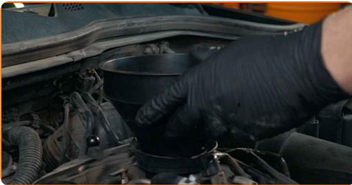
30 Füllen Sie Öl durch den Einfüllstutzen in den Motor. Erforderliche Menge an Öl: 4,7 l.
