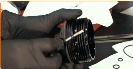
17 Reinigen Sie die Ölfilteraufnahme. Verwenden Sie Allzweckreinigungsspray.
