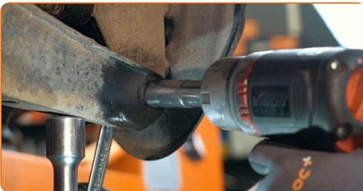
**13** Entfernen Sie die Befestigungsschraube.
