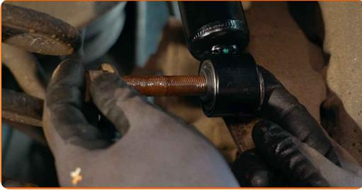
**34** Schrauben Sie das untere Befestigungselement des Stoßdämpfers ein. Verwenden Sie Stecknuss Nr. 21. Verwenden Sie einen Ratschenschlüssel.
