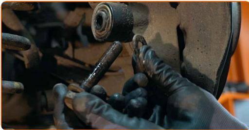
**16** Schrauben Sie das obere Befestigungselement des Stoßdämpfers ab. Verwenden Sie Stecknuss Nr. 16. Verwenden Sie einen Ratschenschlüssel.
